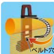
ベルトをシッカリ桟に巻き付けた事を確認後、「ベルト穴」上の「ベルト止め」の突起にベルトをはめ込んでセットOKです。
