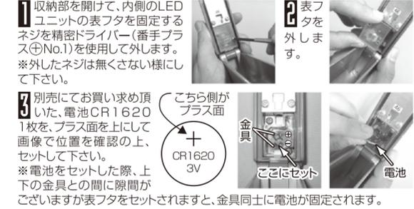
電池寿命 (日本製新品電池使用の場合) 点灯回数 800~1000回(1回約30秒)
