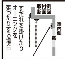
**フックの取付け方** ※一度取り付けた後外れにくいので、フックの取り
