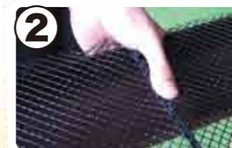
② 取付け専用パーツに成型された「突起箇所2ヶ所」にネットをはめ込む様に押し込み取付ける。
