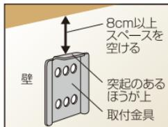
フックを取り付けたい場所(壁)に、取付金具を押し当てます。その時、取付金具は上部に突起がある方を上向きにして壁に押し当てます。
