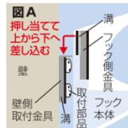
取付金具を壁に取り付けた後、フック本体裏側の金具と接続させます。接続は壁側の金具に、本体側の金具を「上から下へ」左右の溝を噛み合わせてスライドさせながら、シッカリと最後まで差し込みます。(図A参照)
