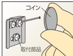
取付金具1個に対して取付部品を3個押し当て、ピンを取付部品の穴から中心に向かって3個共に斜め方向に差し込み、平らな金属(コイン等)を使用して、取付部品3個共に3ヶ所の穴に3本のピンを1本ずつ最後迄押し込んで下さい。(押し込む際、ピンが曲がらない様に気を付けて下さい)
