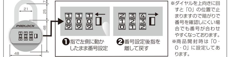
1 番号を「0・0・0」に合わせて解錠状態にしてダイヤル右側レバーを左に動かしながら(図①)お好みの番号に設定します。(番号設定中はレバーは左に動かしたまま設定します。レバーから手を離すとレバーが元に戻り、戻った時点で番号に設定されますのでご注意ください)
