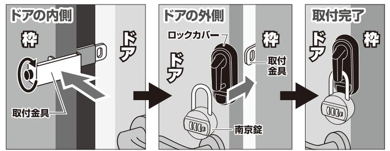
取付金具をドア枠にはめ、ツマミを回してドア枠にしっかり固定し、ドアを閉めるときに取付金具とドアが当たらないか確認します。
