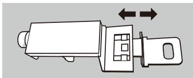
取付金具の先端が稼働しますので、ドア厚み 35~40mm まで対応出来ます。(カラー面裏の取付可能寸法をご参照下さい) 金具先端のロックカバーを差し込む際は、金具の先端をしっかりと引き出してからロックカバーを差し込み、南京錠で施錠して下さい。
